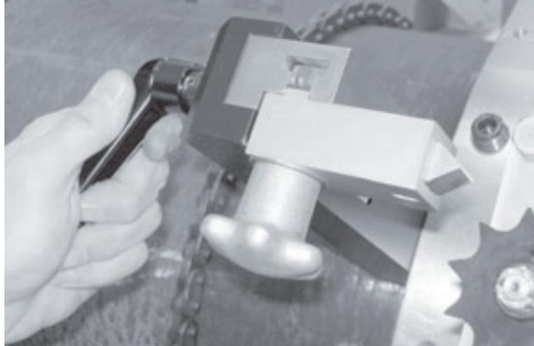
*Figura 3-14. Enganche el desenganche aflojando la palanca de bloqueo de desenganche y empuje la barra de desenganche hacia adentro hacia la LCSF.*
