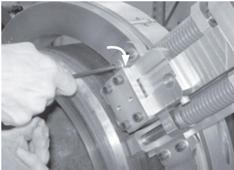
*Figura 3-12. Una vez que las posiciones estén ajustadas, apriete firmemente los tornillos de las abrazaderas de montaje.*
