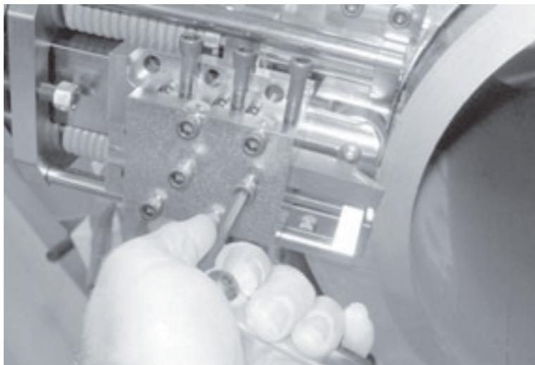
*Figura 3-19. Atornille los tornillos de ajuste superiores para sujetar la herramienta de biselado en su lugar.*
