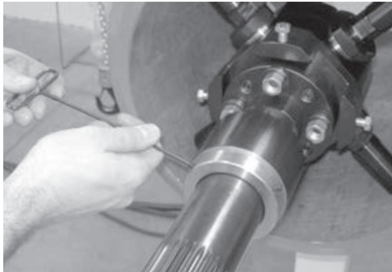
Abbildungen 5-22. Positionieren Sie den Ring in der Nähe der Rohroberfläche und ziehen Sie die Stellschrauben an, um diesen in seiner Position zu sichern.
