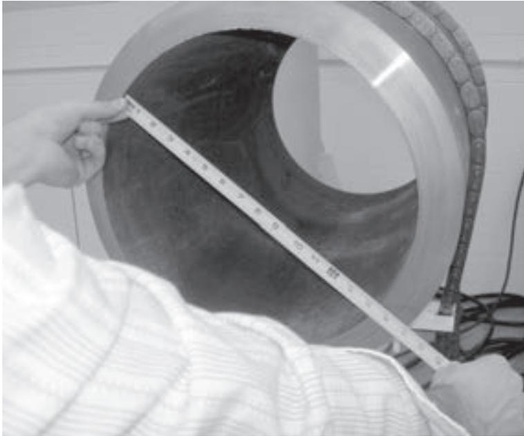
*Abbildungen 5-1. Messen Sie den Innendurchmesser des Rohrs, um zu bestimmen, welcher Spannfußsatz erforderlich ist.*
