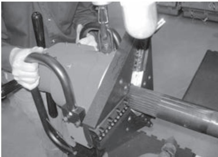
Abbildungen 5-43. Positionieren Sie die Maschine, um sie am Spanndorn zu montieren.
