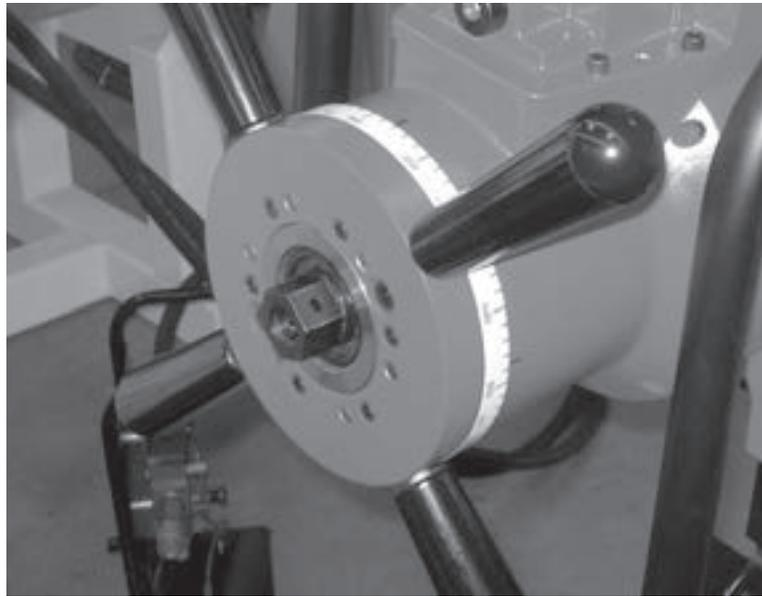
*Abbildungen 5-65. Lassen Sie die Spanndorngewinde für einen sicheren Betrieb vollständig in die Vorschubmutter eingreifen.*
