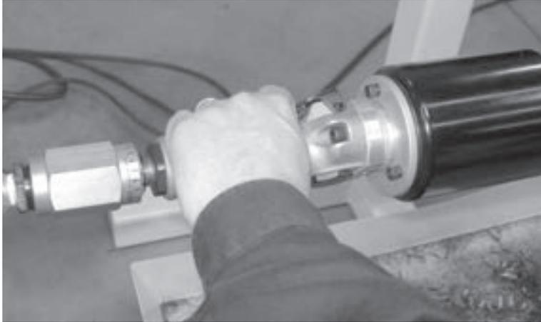
Abbildungen 5-29. Drücken Sie den Druckluftmotorauslöser, um die Maschine zu starten.
