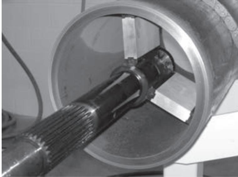
*Abbildungen 5-5. Führen Sie die Spannfüße in das Rohr ein.*
