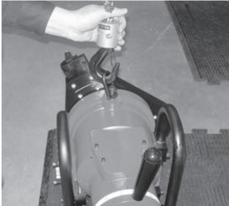
Abbildungen 5-42. Befestigen Sie die Hebevorrichtung an der Hebeöse.
