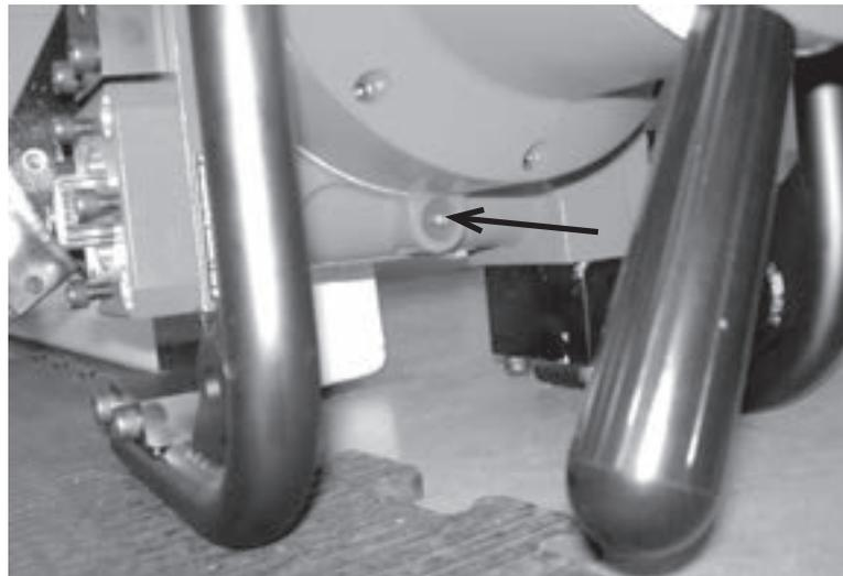
*Abbildungen 6-1. Dieser Schmiernippel befindet sich an der unteren Seite des Gehäuses der Hauptantriebsbaugruppe.*
