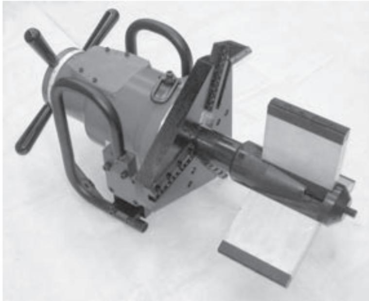
*Abbildungen 3-1. Auf der Abbildung wird die Formwerkzeugkonfiguration der Maschine mit dem standardmäßigen selbstausrichtenden Spanndorn dargestellt.*
