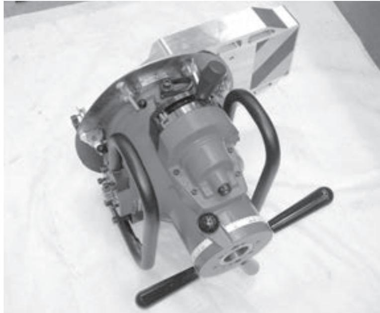
Abbildungen 3-2. Das Foto zeigt die einschneidige Konfiguration der EP 424.
