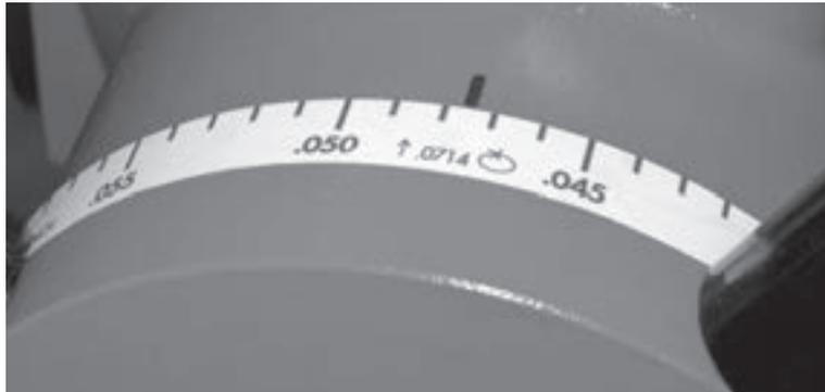
Abbildungen 5-49. Verwenden Sie die Skala auf dem Vorschubgehäuse, um die axiale Vorschubdistanz zu messen.
