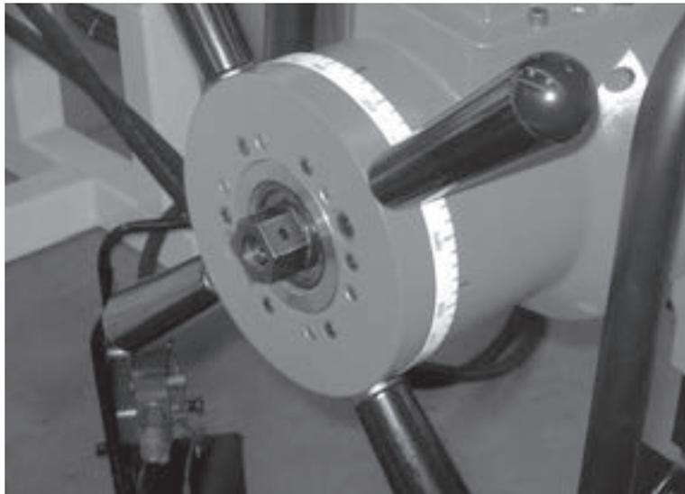
*Abbildungen 5-46. Lassen Sie die Spanndorngewinde für einen sicheren Betrieb vollständig in die Vorschubmutter eingreifen.*
