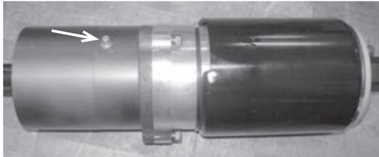
*Abbildungen 6-8. Schmieren Sie den Druckluftmotorschmiernippel einmal im Monat.*
