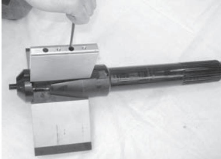
Abbildungen 5-2. Schrauben Sie die unverlierbaren Schrauben in den Spanndorn, um die FüÙe zu sichern.
