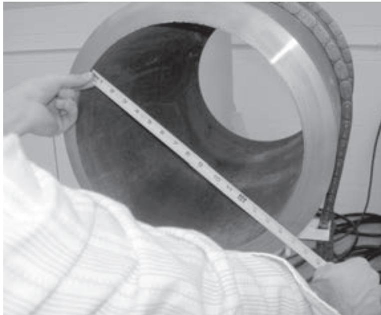
Abbildungen 5-8. Messen Sie den Innendurchmesser des Rohrs, um zu bestimmen, welcher Spannfußsatz erforderlich ist.
