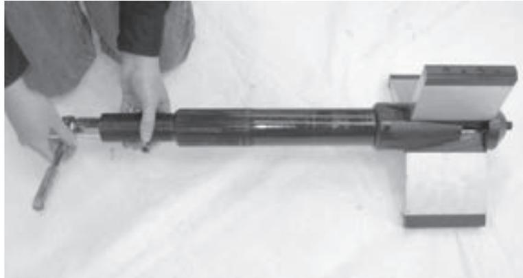
*Abbildungen 5-4. Drehen Sie die Zugstangen-Mutter gegen den Uhrzeigersinn, um die Spannfüße zurückzuziehen.*
