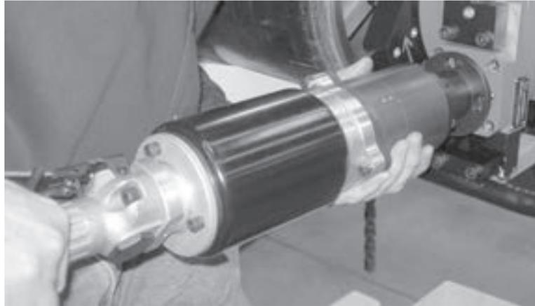
Abbildungen 3-9. Das Foto zeigt den Druckluftmotor der EP 424.
