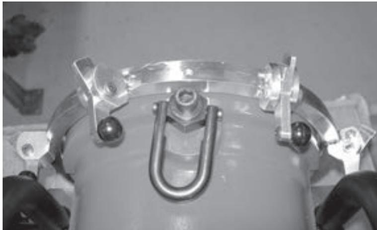
Abbildungen 3-4. Das Foto zeigt die auf dem Hauptantriebsgehäuse montierte Auslöserbaugruppe.
