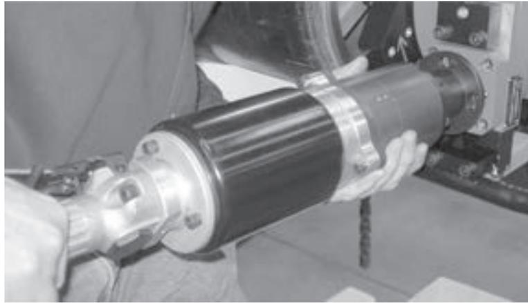
Abbildungen 5-27. Setzen Sie den Druckluftmotorflansch über die Schrauben im Motoradapter.
