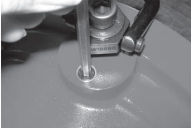
Abbildungen 6-2. Entfernen Sie den Fettstopfen, bevor Sie Fett in die Hauptantriebsbaugruppe einfüllen.
