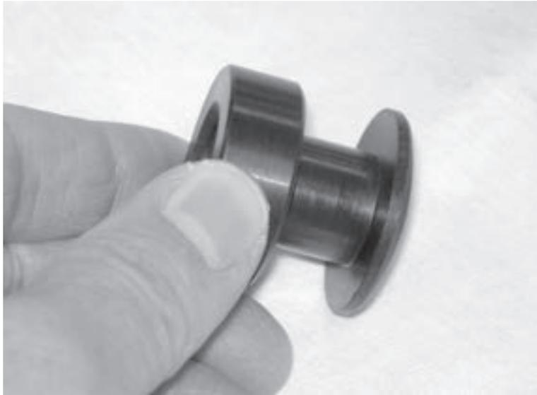
*Abbildungen 5-11. Falls erforderlich setzen Sie einen Abstandhalter auf jedes Spannknopfe.*
