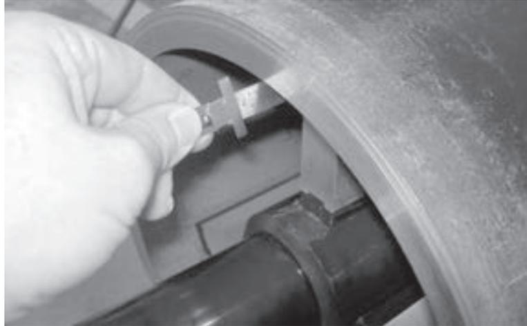
Abbildungen 5-7. Messen Sie den Abstand vom Rohrende bis zu den Spannfüßen, um sicherzustellen, dass für den Betrieb genug Spiel vorhanden ist.
