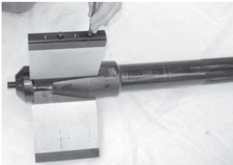
Abbildungen 5-3. Verwenden Sie bei der Installation mehrerer FüÙe die StahlverlängerungsfüÙe (Nr. 1 oder 2) ganz oben.
