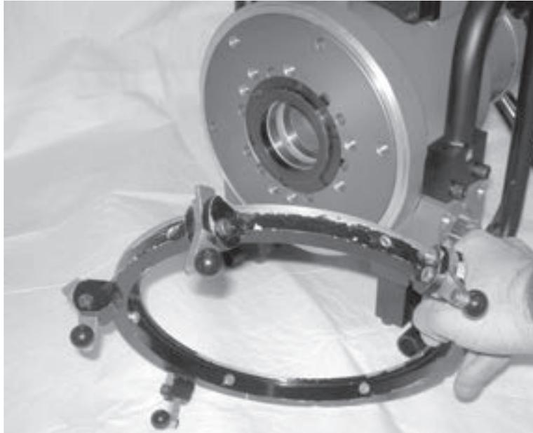
*Abbildungen 5-75. Entfernen Sie die Auslöserbaugruppe.*
