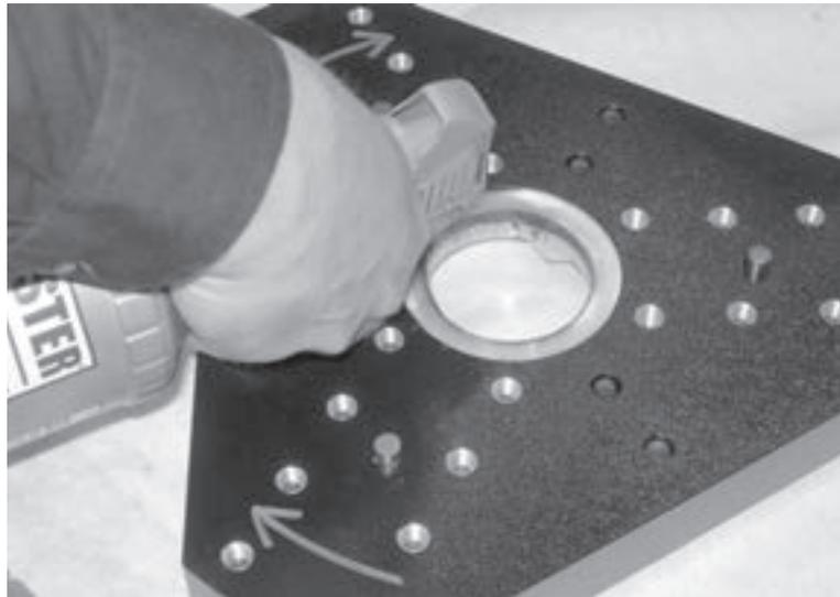
Abbildungen 6-4. Bringen Sie Öl auf den Filzabstreifer im rotierenden Werkzeugkopf auf.
