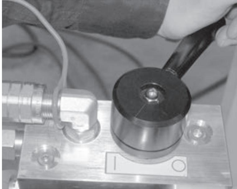
Abbildungen 5-34. Drehen Sie den Hydraulikhebel wie dargestellt auf die Position EIN.
