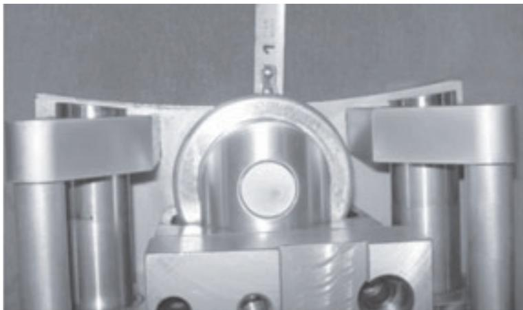
Figura 3-4. Verificare che la ruota di copiatura si estenda di almeno 3 mm oltre la base della slitta.
