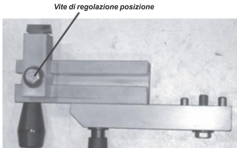
Figura 3-7. Allentare la vite di regolazione della posizione per regolare radialmente l'innesco.
