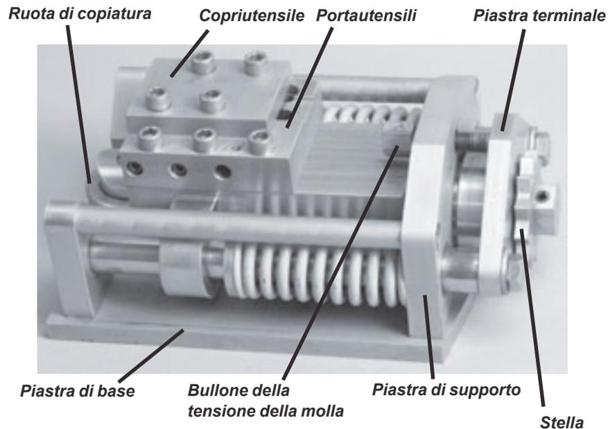
Figura 1-1. La foto illustra i principali componenti della slitta portautensili con copiatore D.E.
