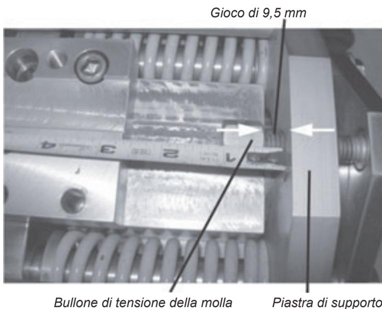
Figura 3-10. Reimpostare il bullone di tensione della molla a un gioco di 9,5 mm dalla piastra di supporto.
