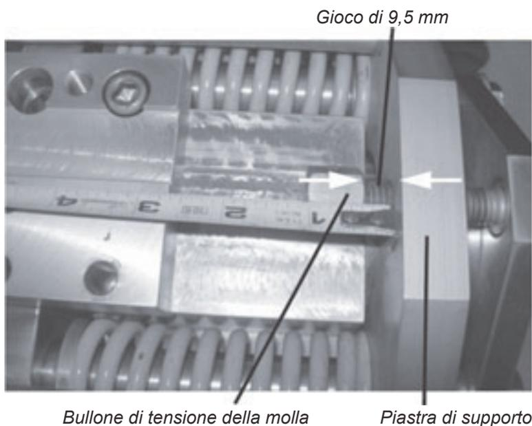
Figura 3-3. Regolare il bullone di tensione della molla a un gioco di 9,5 mm dalla piastra di supporto.
