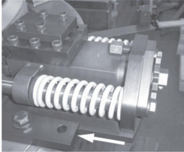
Figura 3-6. Far scorrere la piastra di base della slitta utensile nei canali dei blocchetti di montaggio slitta fino a mettere in contatto la ruota di copiatura con la superficie del tubo.
