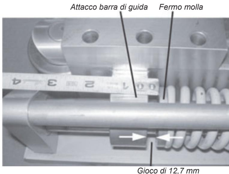
Figura 3-9. Reimpostare la slitta con un gioco di 12,7 mm tra gli attacchi per la barra di guida e i fermi della molla.
