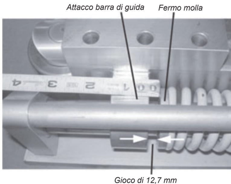
Figura 3-2. Impostare la slitta con un gioco di 12,7 mm tra gli attacchi per la barra di guida e i fermi della molla.
