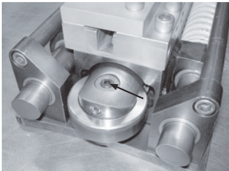
Рис. 4-2. Снимите пробку смазочного патрубка и установите смазочный фитинг для смазывания ролика модуля слежения за наружным диаметром. После смазывания ролика снимите фитинг и установите пробку.
