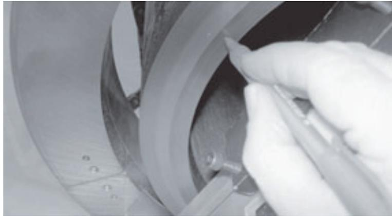
*Abbildungen 3-57. Sie können die endgültige Fasenposition auf dem Rohr markieren, um feststellen zu können, wann Sie sich kurz vor dem letzten Durchgang befinden.*
