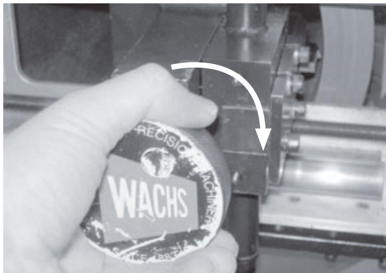
Abbildungen 3-29. Fahren Sie den Werkzeugschlitten für Außenbearbeitung mit der Stellschraube zurück.
