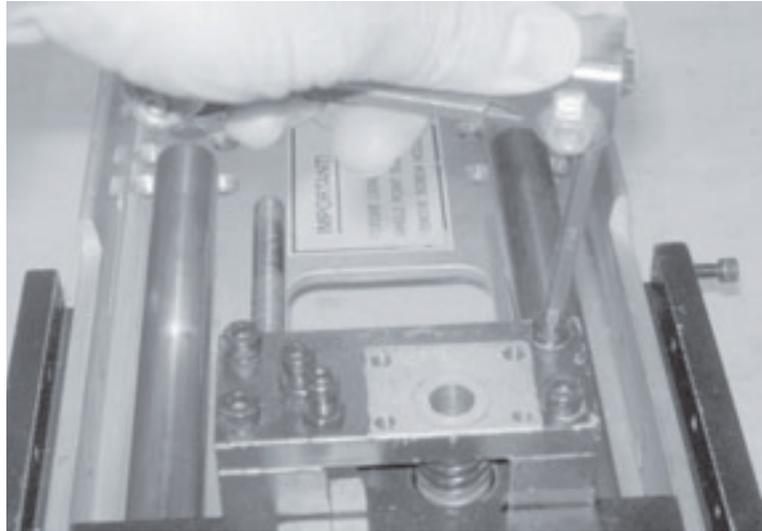
*Abbildungen 4-7. Entfernen Sie die Schrauben, mit denen die Federplatte befestigt ist. Drehen Sie jede Schraube abwechselnd einige Umdrehungen heraus, sodass die Feder die Platte gleichmäßig nach oben drückt.*
