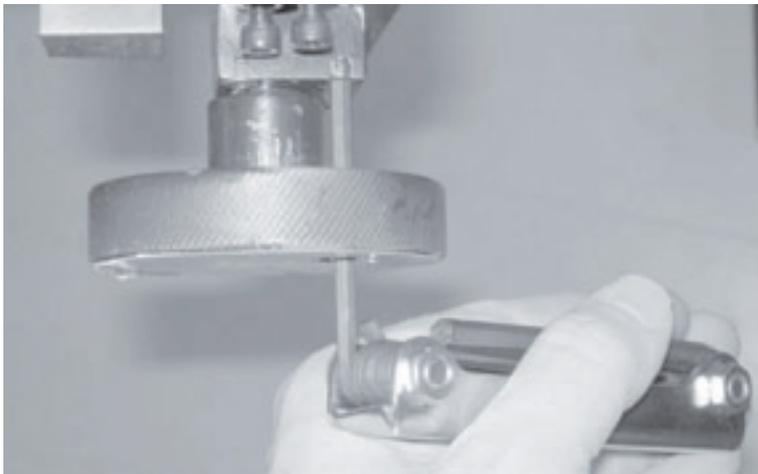
Abbildungen 3-49. Entfernen Sie die vier Schrauben des Endblocks mit einem Sechskantschlüssel. Drehen Sie die Stellschraube, um auf jede Schraube zuzugreifen.
