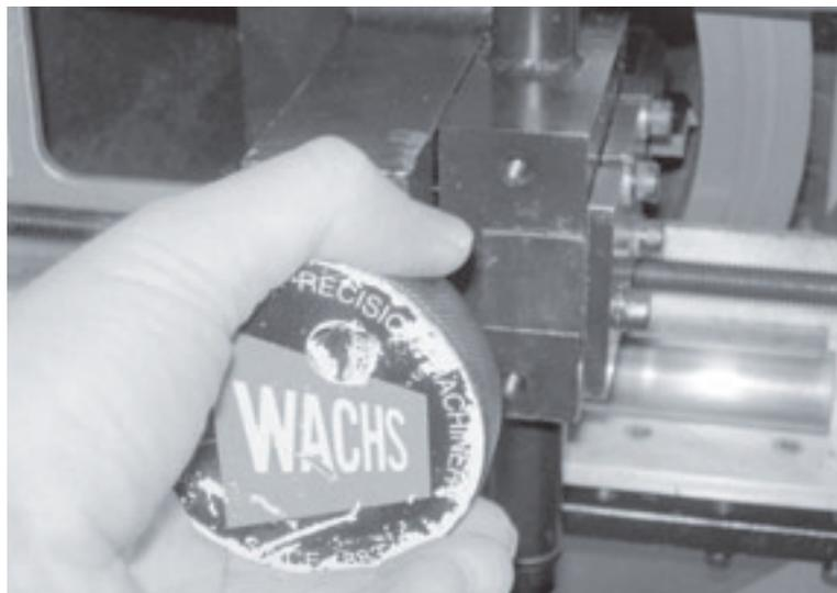
Abbildungen 3-21. Ziehen Sie das Werkzeug aus dem Rohr zurück, indem Sie die Stellschraube im Uhrzeigersinn drehen.
