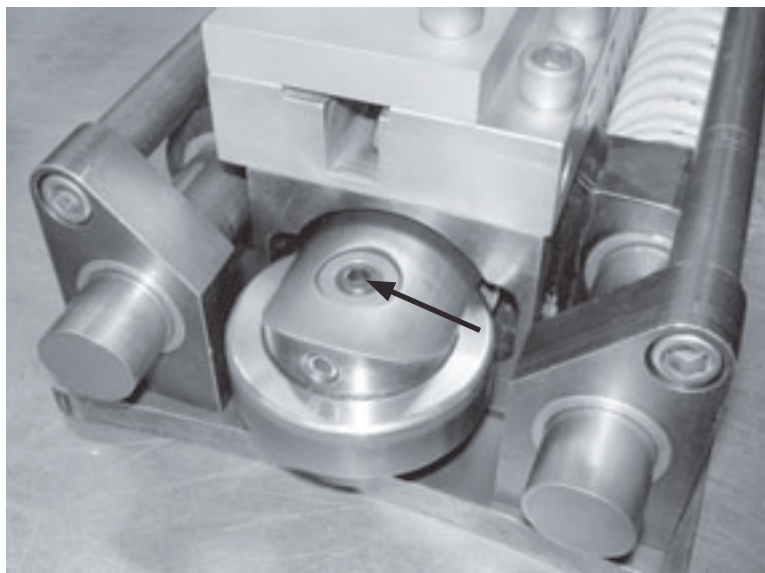
Figure 4-2. Démontez le bouchon et montez un graisseur pour lubrifier la roue suiveuse. Après avoir lubrifié la roue, démontez le graisseur et remontez le bouchon.
